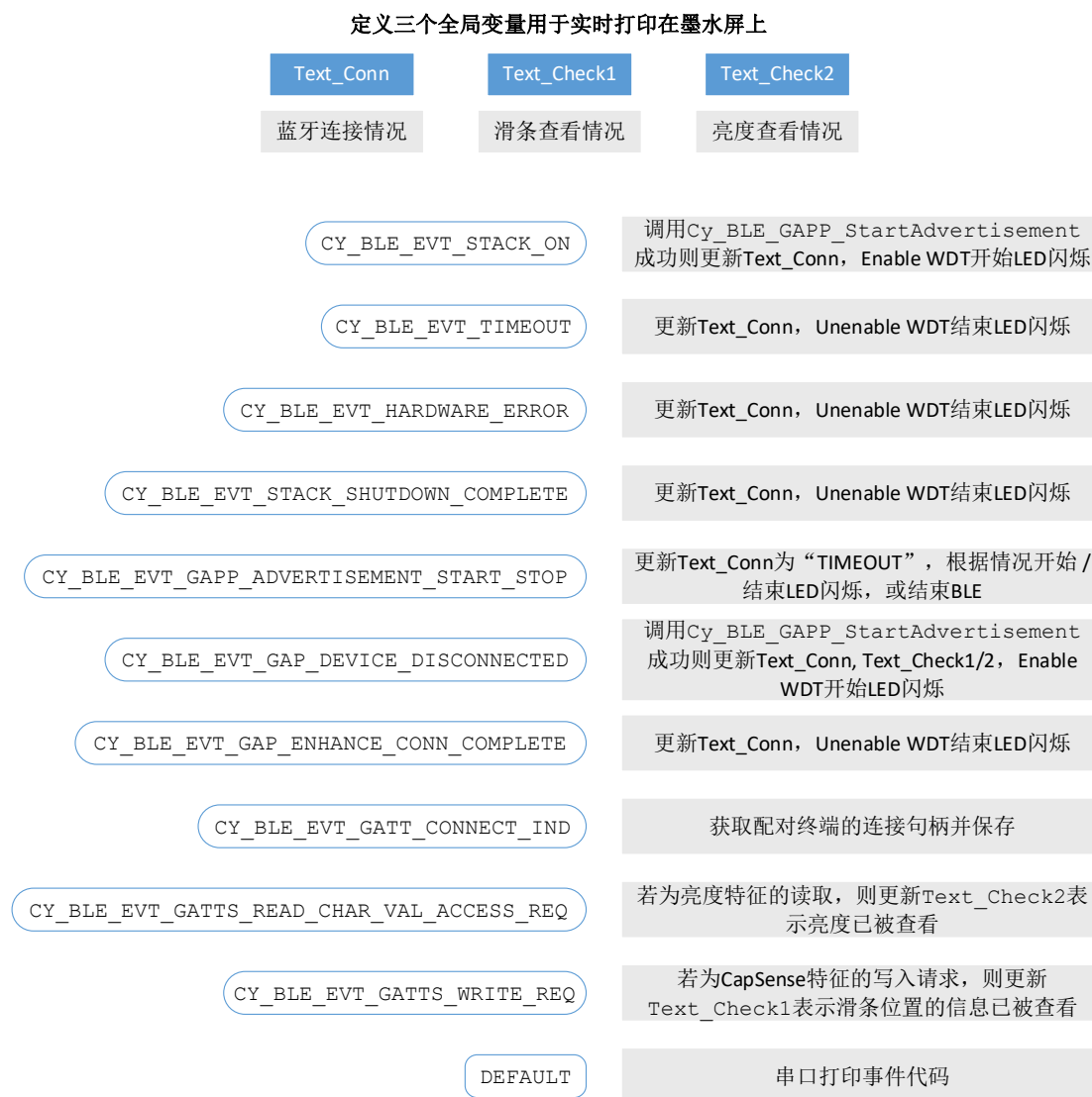
图 13 蓝牙事件与笔者定义的对应操作 (上方三个变量为实时打印在 EINK 上的字符串变量)
